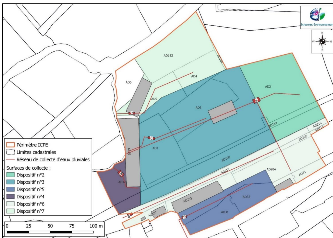
Figure 1 : Représentation schématique mise à jour des dispositifs de traitement des eaux pluviales et bassins de collecte – Situation projetée – Figure issue du PAC de 2023
